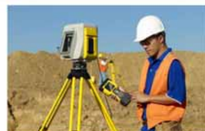
最も測量機に近い3Dレーザースキャナ
